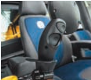
Umschalttaste und Entsperrung des Fahrhebels (hinten).
