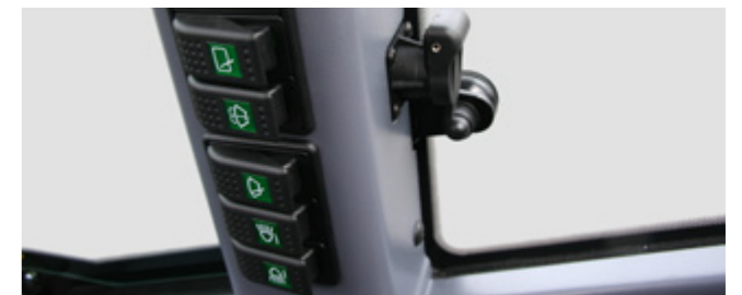
Zusammengefasste Schalterleiste, Steckdose mit Dauerstrom
