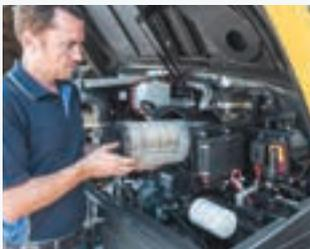
Die aufstellbare Motorhaube wird durch Gasdruckfedern abgestützt und ermöglicht einen ungehinderten Zugang zum Motorraum.
