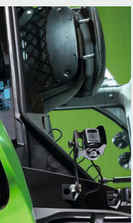
3 Integrierte Kamera mit automatischen Vollbildmodus (z. B. Rückwärtsfahrt) schafft Übersicht und Sicherheit.
