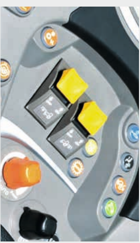
Die Zapfwelkeneinstellung und -aktivierung ist griffungstunlich in die Armlehne integriert...
