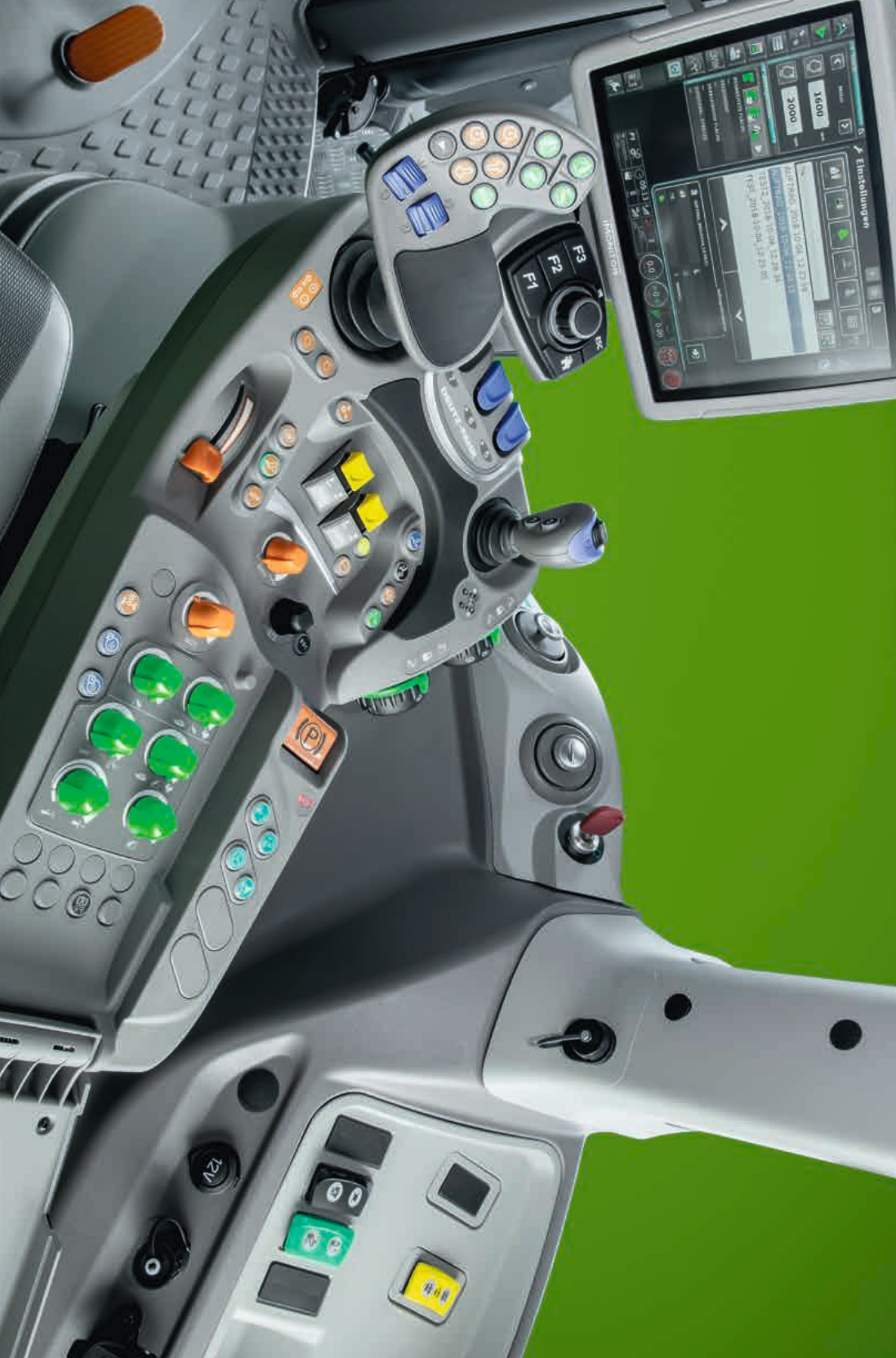
Über den Kreuzhebel mit Wippschalter lassen sich die hydraulische Steuergeräte bedienen.
