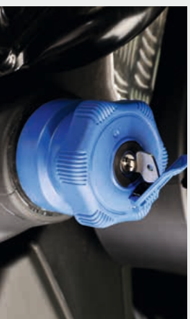
3 Abschließbare Tankdeckel für Kraftstoff- und AdBlue-Tank.
