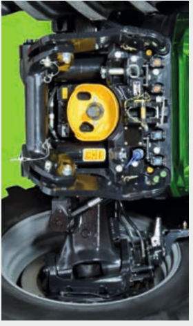
2 Vorderachse: Maximaler Federeffekt und ein Lenkschlagwinkel von bis zu 50 Grad – das sichert höchste Wendigkeit.
