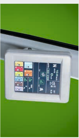
3 Drei Fahr- bzw. Arbeitsstrategien sind wählbar: Manuell, Automatik und PRO. Sie werden auf dem Workkkontor angezeigt.
