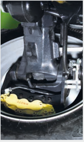
4 Trockene Scheibenbremsen an den Vorderachsen für extrahierbare Bremswirkung (optional).
