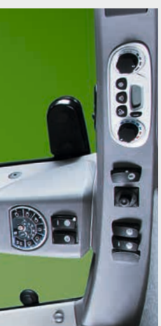
3 Fahrlicht, Arbeitssicht und Kabinenlicht in einem. Bedienpanel zusammengefasst. Arbeitsskizze vorhanden, die Automatik steuert die Luftströme präzise.
