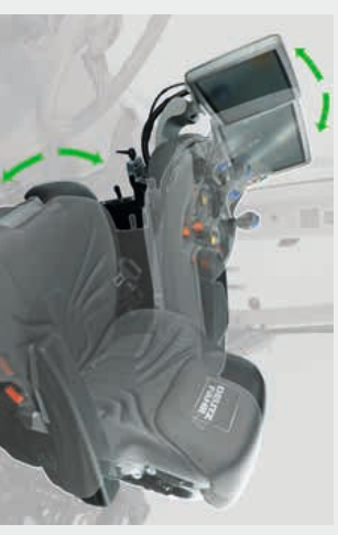
2 jetzt neu für alle TVV-Modelle: Bis zu 20° drehbarer Sitz für erhöhten Bedien- und Arbeitskomfort.
