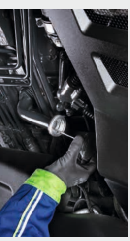
3 Der Ölstand kontrollieren und Öl nachfüllen geht spielend leicht von der Hand.
