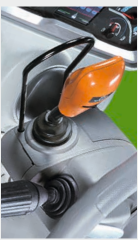
3 Serienmäßige Powershuttle-System. Die Empfindlichkeit (hard – medium – soft) wird einfach mit dem Daumen eingestellt.
