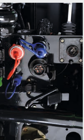
2 Die DEUTZ-FAHR ISOBUS-Schnittstellen in Heck und front machen den Traktor mit den Anbaugeräten aller namhaften Hersteller kompatibel.
