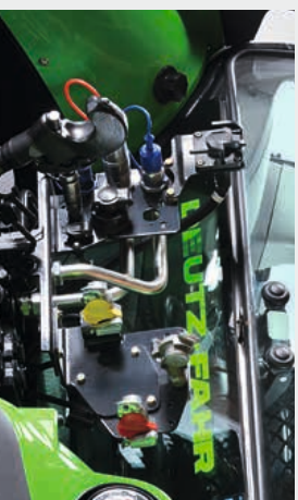
3 Die Druckluftbremsanlage bremst Anhänger aller Gewichtsklassen zuverlässig und sicher.
