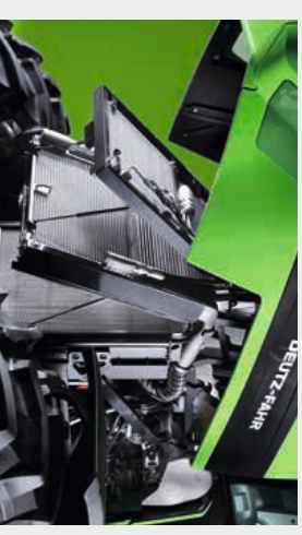
2 Der Motorlüfter ist einfach aufzuklappen und leicht zu reinigen.
