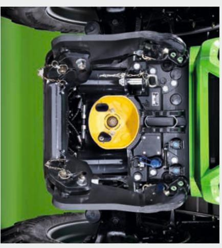
Integrierter Frontkralleheber mit einzigartig kurzer Distanz zur frontadsche Gefinger Überhang. Beste Traktionsbalance.
