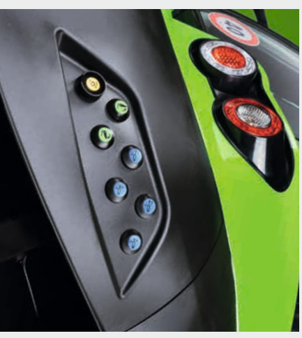
Externe Steuerung der Hydraulik- und Zapfwellenfunktionen von beiden Seiten möglich.
