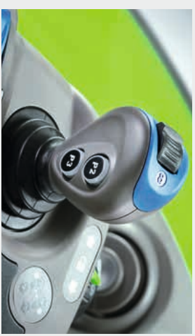
Über den Kreuzhebel mit Wippschalter lassen sich die hydraulische Steuergeräte bedienen.
