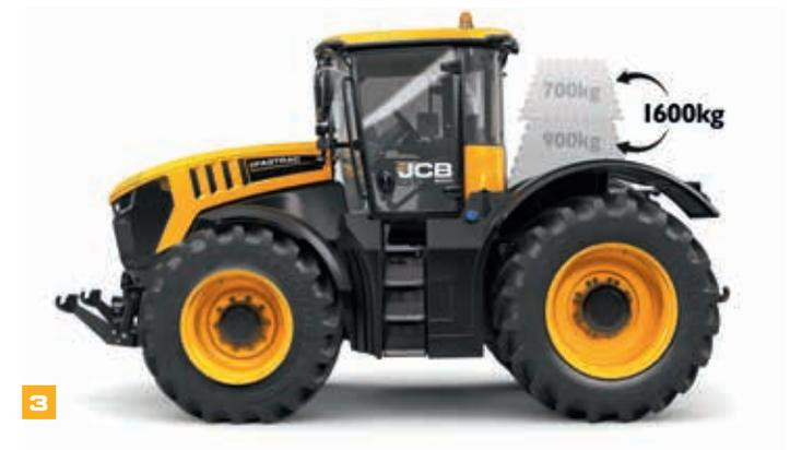
5 Man weiß, dass eine Vorderachsfederung vertikale Radschwingungen beseitigt und somit die Traktion erhöht – weniger bekannt ist, dass dies auch auf eine Hinterachsfederung zutrifft. Das ist einer der Gründe für die außergewöhnlich gute Traktion des Fastrac.
