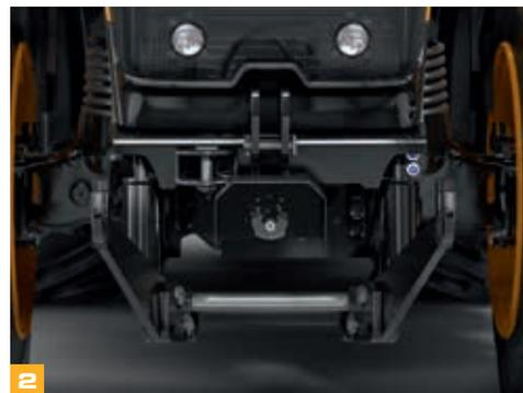
**3** Das maximal zulässige Gesamtgewicht von 16.000 kg können Sie für optimale Traktion ausnutzen, indem Sie die Heckplattform mit ihrer Tragfähigkeit von 2,5 Tonnen mit Ballastelementen von 900 kg oder 1600 kg versehen.
