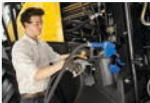
Der Kraftstofftank und der 200 Liter fassende AdBlue-Tank sind nebeneinander montiert, was das Nachfüllen erleichtert.
