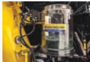
Die automatische Zentralschmierung ist leicht zugänglich.
