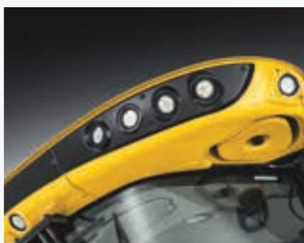
Die Beleuchtungsanlage des FR umfasst bis zu 20 Arbeitsscheinwerfer (17 LED-Scheinwerfer) 11 LED-Scheinwerfer sind so im Dach angeordnet, dass eine optimale Lichtverteilung gewährleistet ist.
