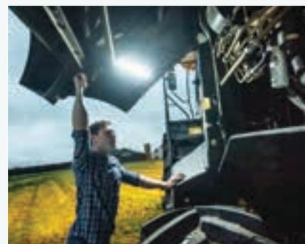
Neue LED-Leuchten hinter den Verkleidungen erleichtern die Ausführung von Wartungsarbeiten bei widrigen Lichtverhältnissen.
