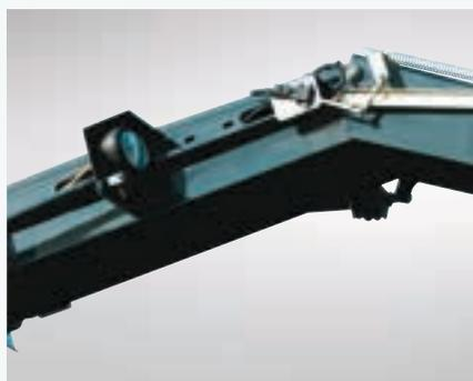
Sechs Arbeitsscheinwerfer sind an wichtigen Arbeitsbereichen montiert, u.a. am Auswurfkrümmer, an der Wartungsplattform und auf dem Stoßfänger zur Ausleuchtung des Frontbereichs.
