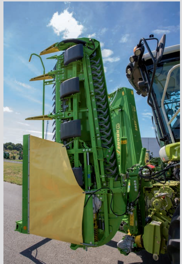
2-Teiler: Den 2-teiligen Maisvorsatz gibt es in den Arbeitsbreiten 4,5 m, 6 m und 7,5 m.
