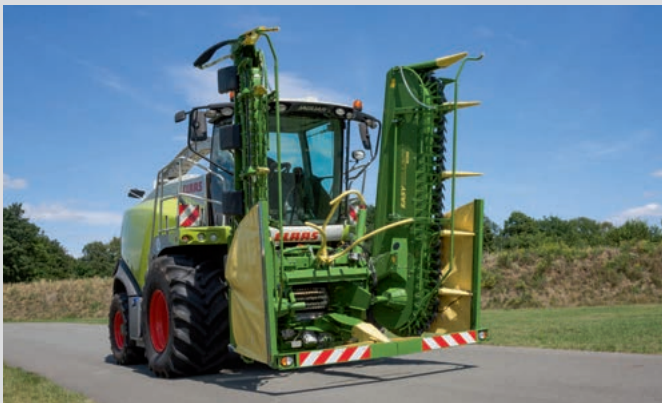
2-Teiler: Den 2-teiligen Maisvorsatz gibt es in den Arbeitsbreiten 4,5 m, 6 m und 7,5 m.
