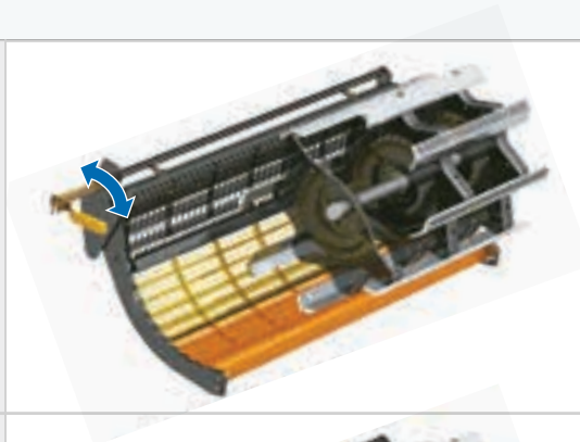
Standardtrommel & mehrteiliger Korb für Getreidedrusch
