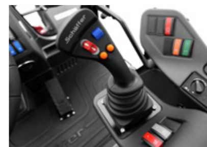
Neuer Joystick mit erweitertem Funktionsumfang
