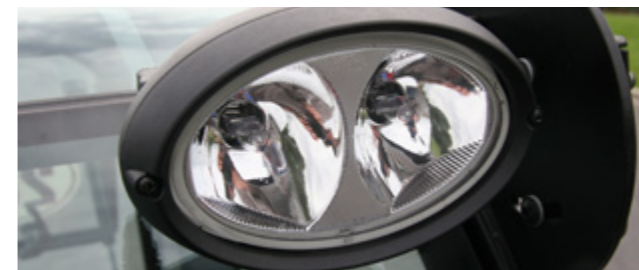
2x Dual Power Arbeitsscheinwerfer vorne, 1x Single Power hinten
