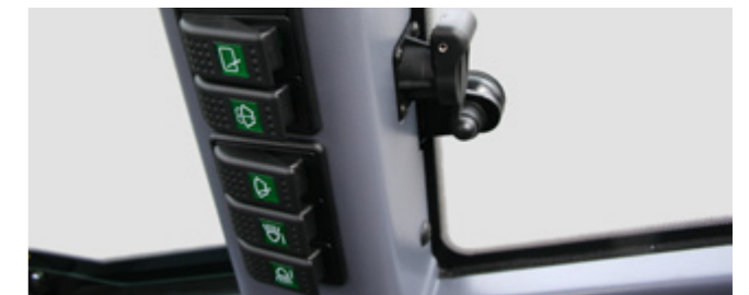
Zusammengefasste Schalterleiste, Steckdose mit Dauerstrom
