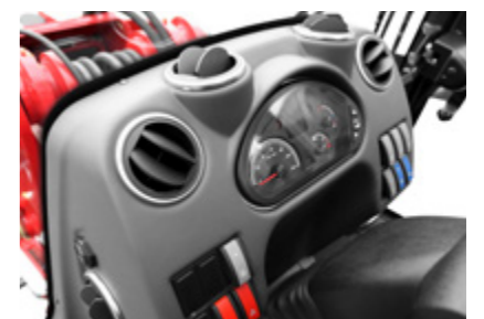
Zusätzliche, größere Luftauslässe für optimale Luftzirkulation / optimierte Schalterbaureihe
