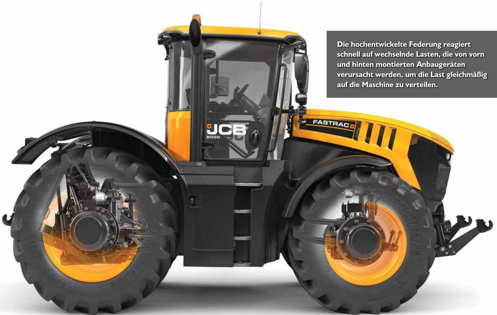
Die hochentwickelte Federung reagiert schnell auf wechselnde Lasten, die von vorn und hinten montierten Anbaugeräten verursacht werden, um die Last gleichmäßig auf die Maschine zu verteilen.
