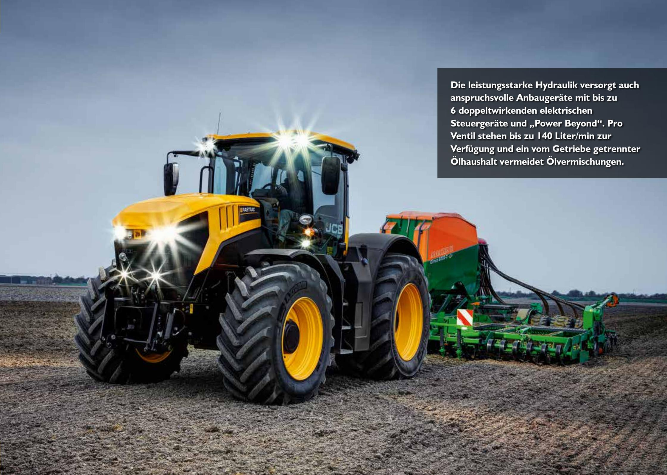
Die leistungsstarke Hydraulik versorgt auch anspruchsvolle Anbaugeräte mit bis zu 6 doppelwirkenden elektrischen Steuergeräte und „Power Beyond“. Pro Ventil stehen bis zu 140 Liter/min zur Verfügung und ein vom Getriebe getrennter Ölhaushalt vermeidet Ölvermischungen.
