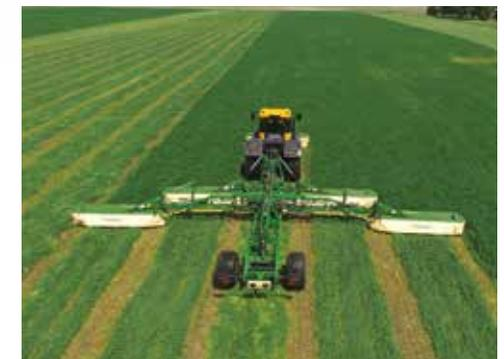
**Heavy-duty Achsen können mit 3 m Spurweite für CTF und Reihenkulturen verwendet werden.**
